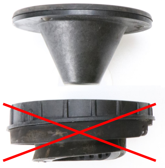
Abb. 4: Obere Federunterlage entfällt, Zentrierkegel wird wiederverwendet
