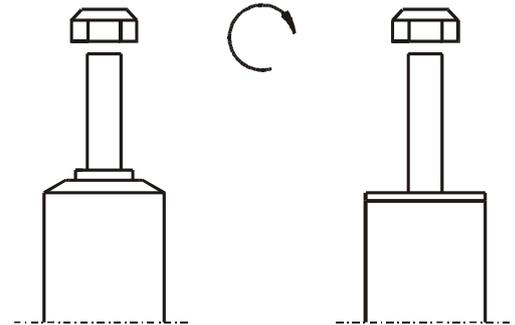
Um eine mögliche Zerstörung des Produktes zu vermeiden, darf zum Lösen und Anziehen der Muttern kein Schlagschraubendreher verwendet werden.
