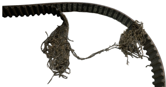
1. sz. ábra: Vezérműsíz levált fogazattal
