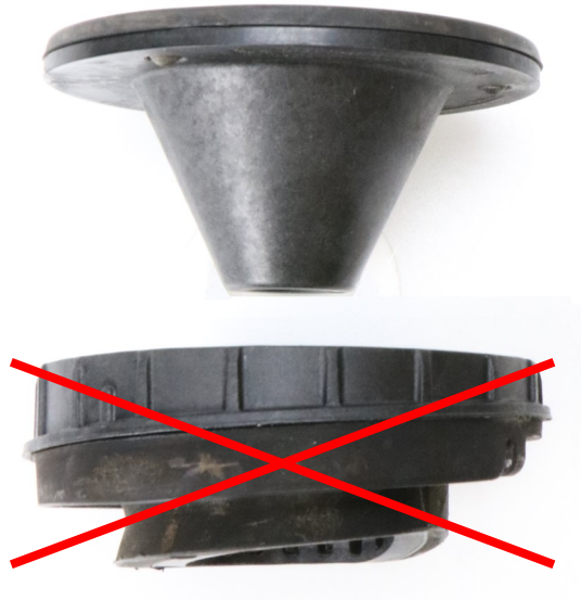
Abb. 4: Obere Federunterlage entfällt, Zentrierkegel wird wiederverwendet Fig. 4: Upper spring pad is omitted, centering cone is reused
