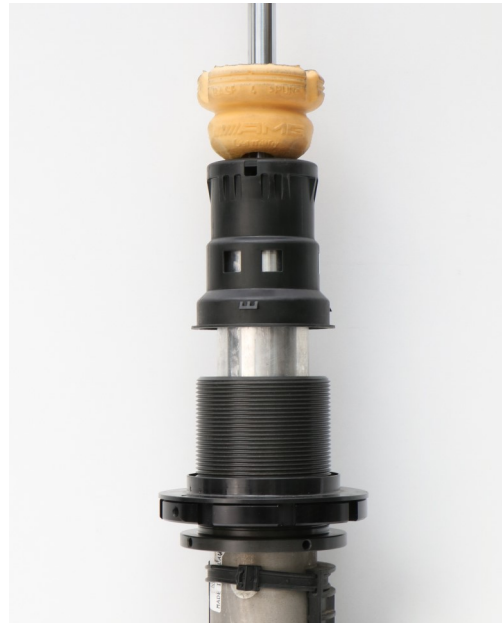
Abb. 2: Höhenverstellung und Abdeckkappe mont. Fig. 2: Mount the height adjuster and cap
