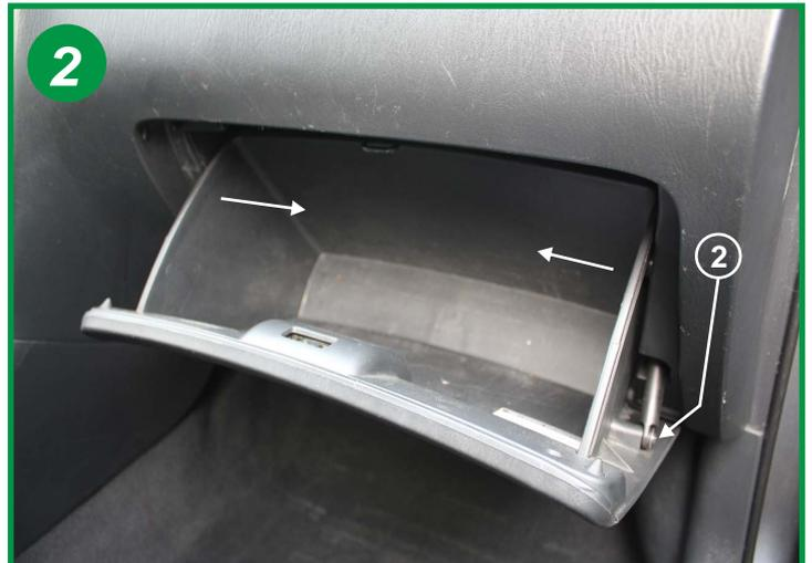
Dévisser la vis cruciforme (2) et libérer l'amortisseur d'ouverture de boîte. Presser sur les flancs de celle-ci vers l'intérieur pour dégager les arrêtoirs. Sortir le tiroir de ses gonds et le mettre sur le côté.
