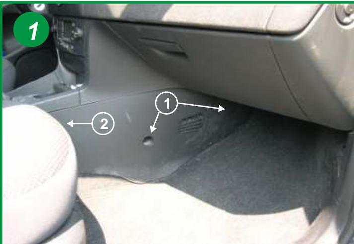
L'élément filtrant habitacle se trouve du côté passager à l'intérieur du véhicule derrière la console centrale, pour le démonter procéder comme suit: retirer la paroi plastique de la console en retirant les 2 clips plastiques (1) et l'agrafe de maintien (2) ATTENTION LES 2 CLIPS SONT FRAGILES ET CASSENT FACILEMENT.
