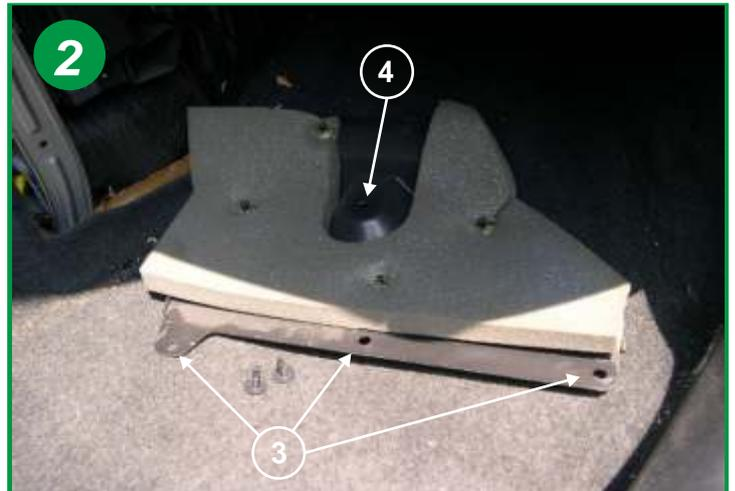
Retirer ensuite le cache situé sous la boîte à gants en enlevant les 3 clips plastiques (3) (pour les extraire il suffit de placer au centre du clips un petit tournevis et d'enfoncer légèrement la partie centrale) et retirer le cache qui est également tenu par un téton cranté (4).
