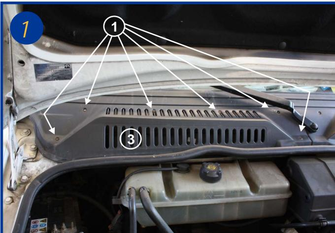
Le filtre d'habitacle est situé sous le capot moteur côté passager. Ouvrir le capot moteur et dévisser les 6 vis torx (1).
