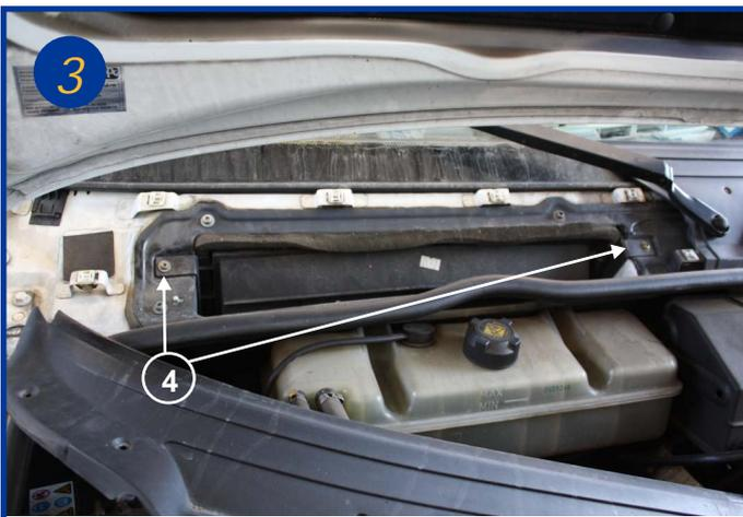
Dévisser ensuite les 2 vis cruciforme qui maintiennent le bloc filtrant en place (4) et le retirer.
