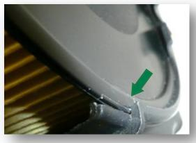
2 Stellen Sie sicher, dass der Rand des Elementbodens durchgehend in der Nut des Gehäuses sitzt.
