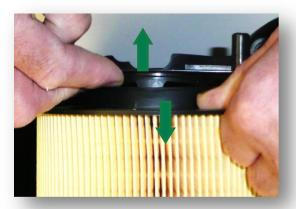
Ziehen Sie die Gehäusewand nach oben, das Element in die entgegengesetzte Richtung. Pressen Sie dabei die flexible Dichtung über die Gehäusenase.
