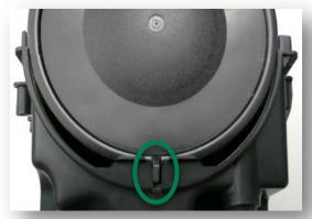
**1** Beim Einlegen des Filterelements sollten Sie darauf achten, dass die Ausricht-kontur in die vorgesehene Aussparung eingeführt wird.
