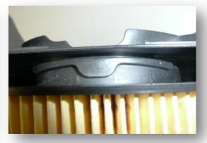
4 Die Dichtung des Elements muss sich hinter der Gehäusenase befinden.
