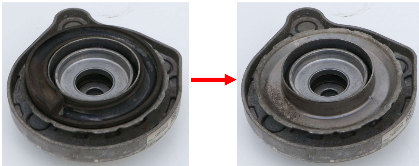
Abb. 1: Das Federschlossgummi wird durch die Höhenverstellung ersetzt
