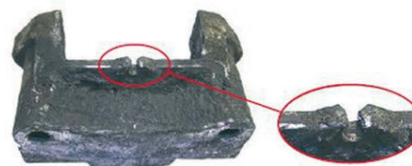
Aufnahme gebrochen / mounting broken
