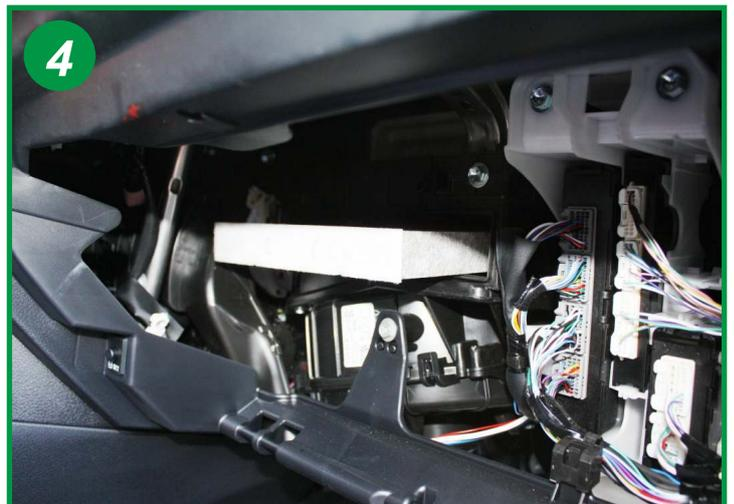
Extraire l'élément filtrant de son logement et procéder à son remplacement. Le remontage s'effectue dans l'ordre inverse du démontage.
