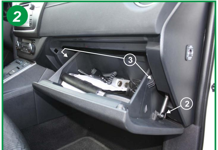
Désaccoupler l'amortisseur d'ouverture de boîte (2), puis presser sur les flancs du tiroir pour dégager les arrêteurs (3), basculer le tiroir vers le bas pour le désolidariser et le retirer totalement.
