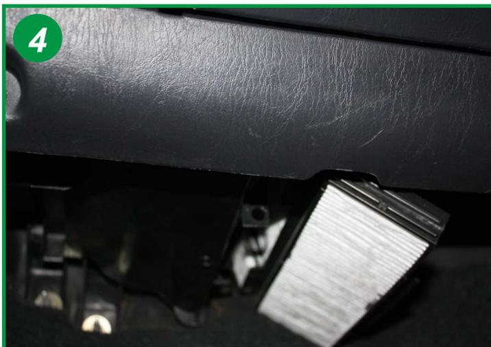
Procéder à son remplacement en pliant le nouvel élément une partie après l'autre pour l'installer correctement. Le remontage s'effectue dans l'ordre inverse du démontage.
