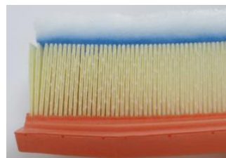
Élément filtrant précédent avec préfiltre bleu foncé
