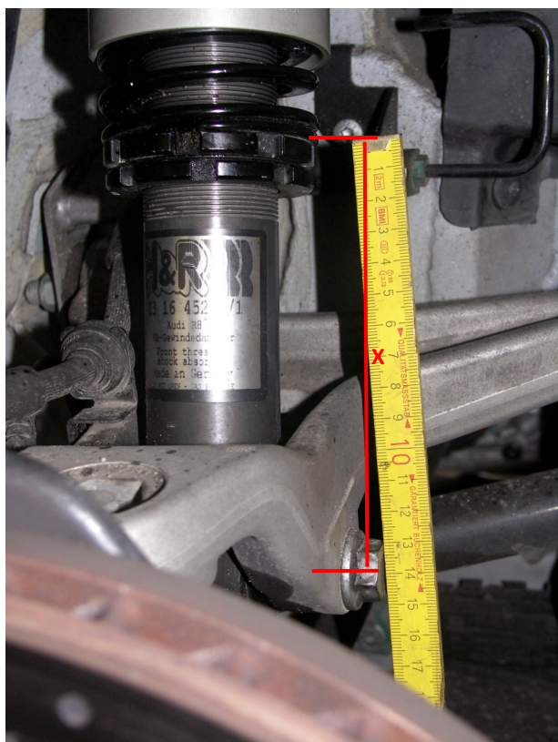
Abb. 1 : Einstellmaß Vorderachse (Abb. ähnlich) Fig. 1: Adj. dimension front axle (Fig. may vary)
