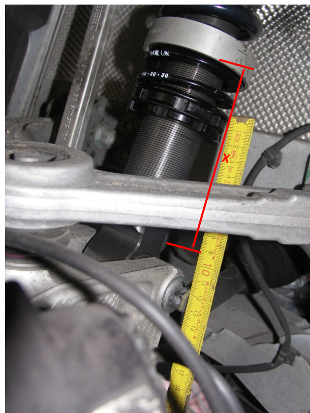
Abb. 2 : Einstellmaß Hinterachse (Abb. ähnlich) Fig. 2: Adj. dimension rear axle (Fig. may vary)
