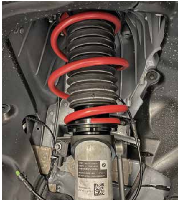
Abb. 8: Eingebauter Zustand: Das untere Federende zeigt zur Fahrzeugaußenseite
