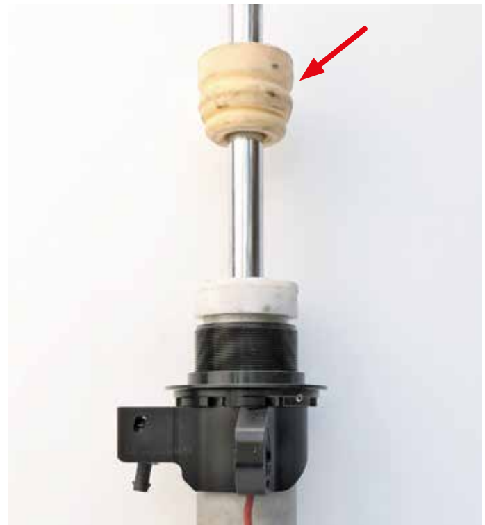
Abb. 4: Anschlagpuffer aufstecken Fig 4: Put the bump stop on the piston rod
