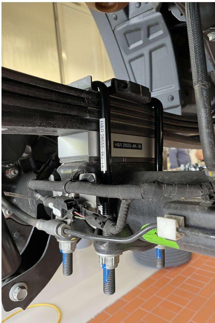
Abb. 2: Einbausituation am Fahrzeug (Abb. ähnlich)
