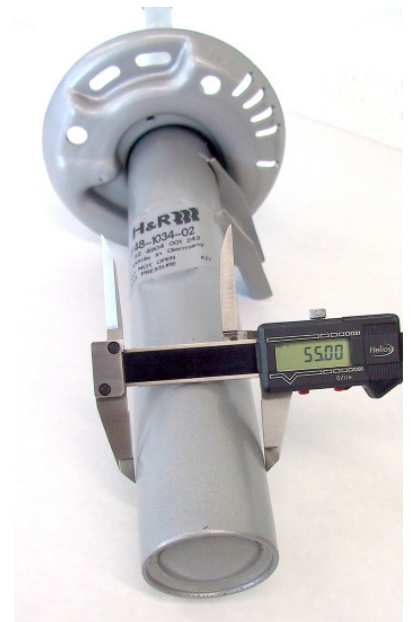
Bild 3: Klemmdurchmesser VA Dämpfer (Abb. ähnlich)
