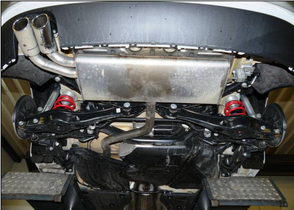
Bild 1: Mehrlenker-Hinterachse (Abb. ähnlich)
