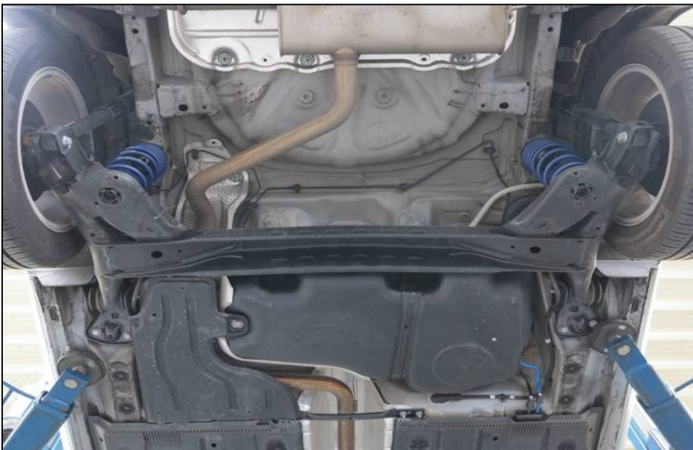
Bild 2: Verbundlenker-Hinterachse (Abb. ähnlich)
