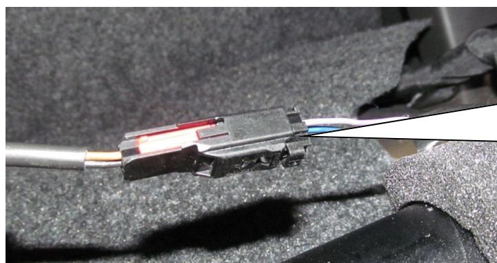
Den Stecker des Stillegungssatzes in die Originalbuchse einstecken. Hierbei auf die korrekte Verriegelung des Steckers achten und anschließend die neue Leitung mit Kabelbindern befestigen.
