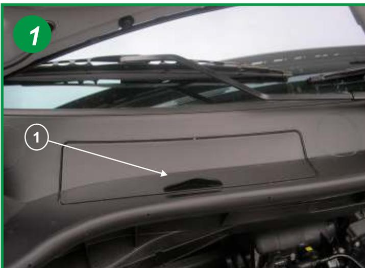
L'élément filtrant est situé sous le capot moteur côté passager sous une trappe (flèche 1)
