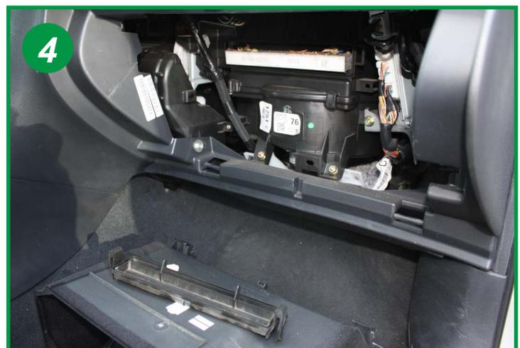
Extraire l'élément filtrant usagé et le remplacer.
