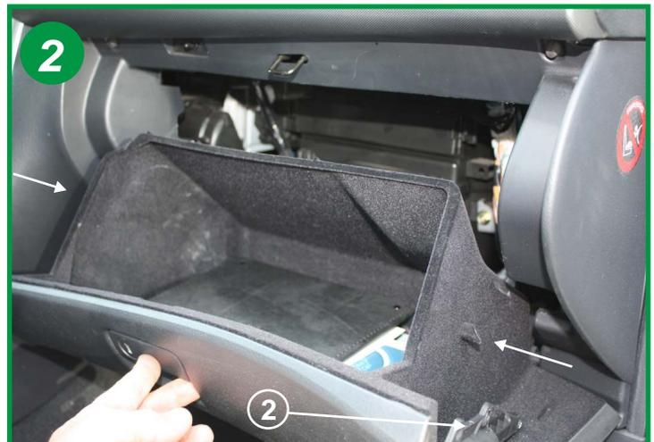
Ouvrir la boîte à gants, appuyer sur les flancs pour dégager les arrêtoirs, dégager également le vérin d'ouverture de boîte (2).
