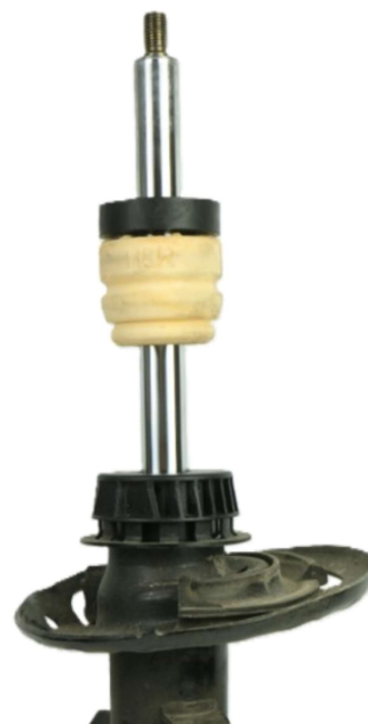
Abb. 1: Anschlagpuffer und Anschlaggummi
