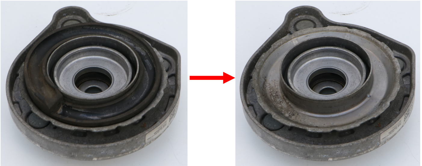
Abb. 1: Das Federschlossgummi wird durch die Höhenverstellung ersetzt Fig. 1: Replace the OE spring lock rubber by the height adjuster
