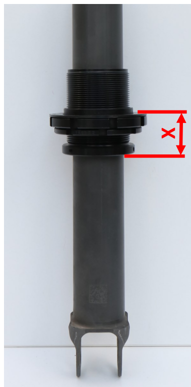
Abb. 7: Einstellmaß X HA (Abbildung ähnlich) Fig. 7: Adjustment dimension X RA (Fig. may vary)
