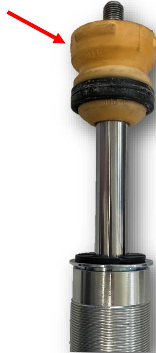
**Abb. 2:** Verwendung Anschlagpuffer (Abb. ähnlich)
