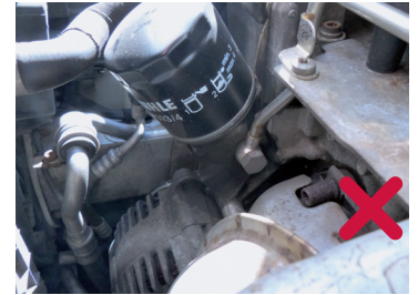
Resim 3: Motor yağı doldurulurken veya yağ filtresi değiştirilirken, gerekirse alternatör korunmalıdır
