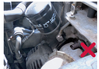
Abbildung 3: Beim Nachfüllen von Motoröl oder dem Wechsel des Ölfilters muss der Generator ggf. geschützt werden
