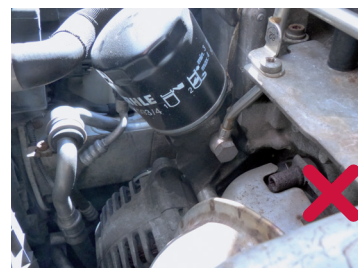
Ilustracja 3: Podczas uzupełniania oleju silnikowego lub wymiany filtra oleju może być konieczne zabezpieczenie alternatora
