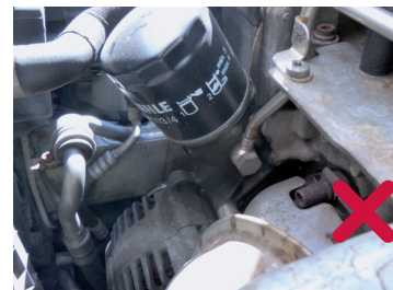
Εικόνα 3: Κατά τη συμπλήρωση λαδιού στον κινητήρα ή την αλλαγή του φίλτρου λαδιού, η γεννήτρια μπορεί να χρειαστεί προστασία
