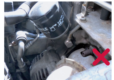
Figura 3: Si es necesario, se debe proteger el alternador al rellenar el aceite del motor o al cambiar el filtro de aceite
