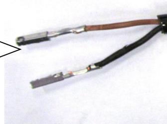
3. Die originale Leitungen wird in den mitgelieferten Stecker eingeschoben bis diese einrastet. Die Pinposition / Kabelfarbe ist in diesem Fall nicht relevant. Anschließend verriegeln den Stecker verriegeln.
