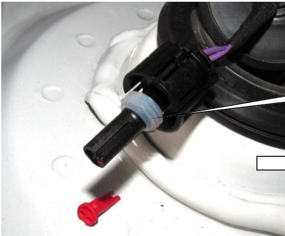
2. Ziehen Sie die rote Steckersicherung aus dem Stecker heraus. Die originale Dämpferleitungen wird anschließend mit einem geeignetem Werkzeug aus dem Stecker ausgepinnt.
