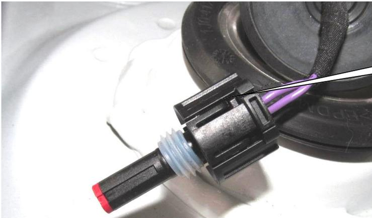
1. Die Originalstecker werden vom Kabelbaum demontiert.
