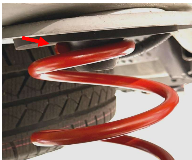
Abb. 8: HA Position Federende Fig. 8: RA position spring end
