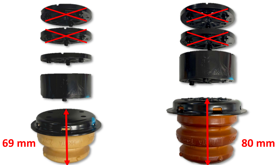
Abb. 4: Einstellmaß 20 - 30 mm: Entfall zweier Distanzstücke Fig. 4: Adjustment dimension 20 - 30 mm: discard two spacers
