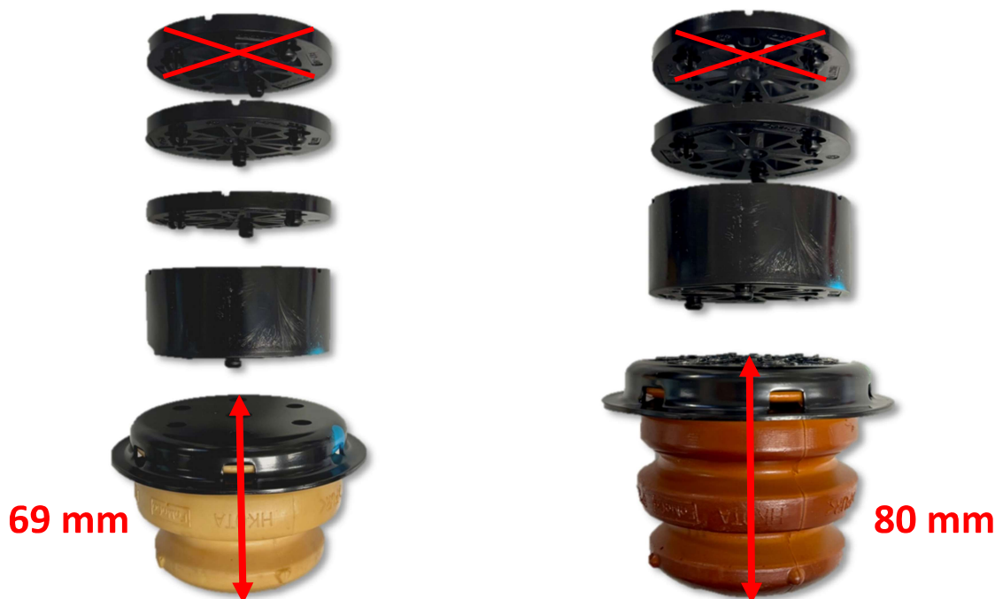
Abb. 4: Einstellmaß 16 - 21 mm: Entfall eines Distanzstückes Fig. 4: Adjustment dimension 16 - 21 mm: discard one spacer
