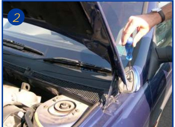
Dévissez les 4 vis torx situées sur les cotés supérieurs droit et gauche du conduit d'aération. Tirez la grille d'aération vers le bas et la déposez sur le pare-brise (la canalisation des gicleurs ne doit pas être enlevée)
