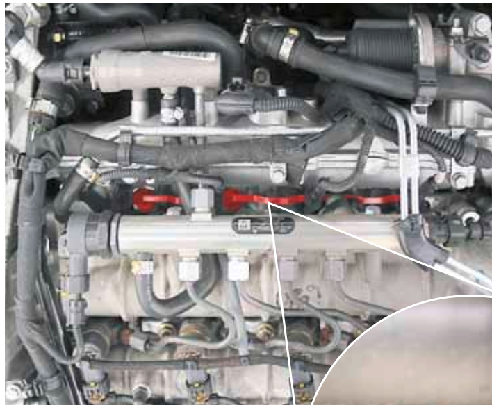
Tringlerie de commande du collecteur d'admission d'Opel Vectra (marqué en rouge et en vue détaillée).
