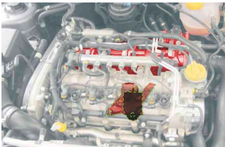
Photo du compartiment moteur d'une Opel Vectra : Collecteur d'admission avec soupape EGR est marqué en rouge. Le module d'entraînement, invisible ici, se trouve « derrière le moteur » et n'est qu'esquissé (ligne en pointillés verte).
