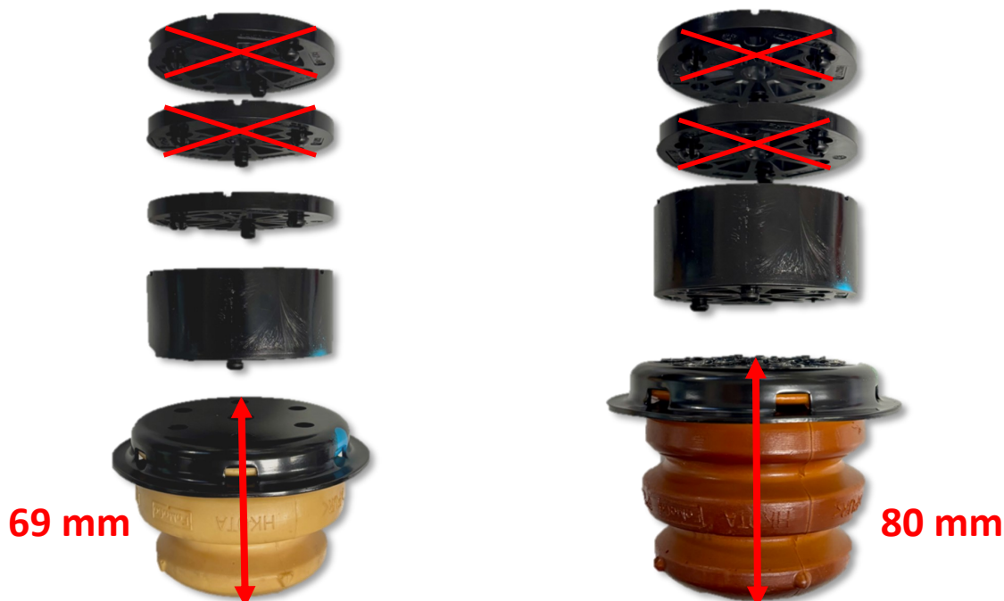
Abb. 4: Einstellmaß 20-30 mm: Entfall zweier Distanzstücke (Abbildung ähnlich) Fig. 4: Adjustment dimension 20-30 mm: discard two spacers (Picture may vary)
