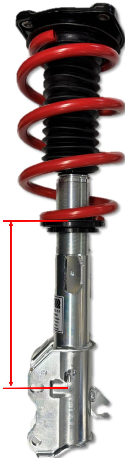
Abb. 3: VA Einstellmaß (Abbildung ähnlich) Fig. 3: FA adjustment dimension (figure may vary)
