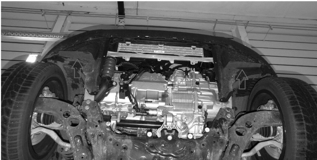
Die Aeroflaps aus Kunststoff, links und rechts **können** bei Bedarf eingekürzt werden.
