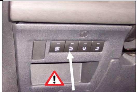
Lors du branchement de la remorque, désactiver le système "RADAR DE RECUL" au tableau de bord
