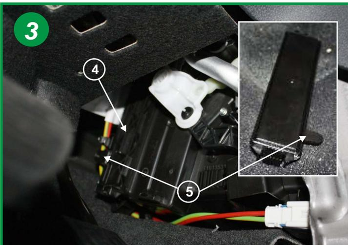
Déclipser le couvercle du boîtier filtrant (4) en agissant sur la poignée (5) dans la partie inférieure de celui-ci. Retirer le couvercle.
