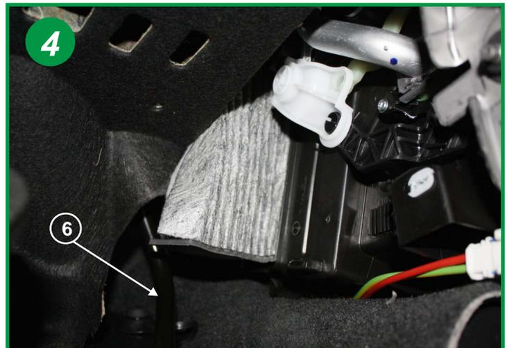
Extraire l'élément filtrant usagé et procéder à son remplacement, il est nécessaire de garder appuyé la pédale d'accélérateur pour retirer le filtre (6).
