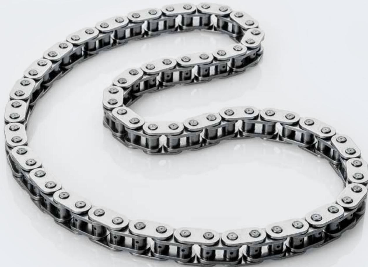
Kurz gesagt, wird bei dieser Technologie mittels physikalischer Gasphasenabscheidung (PVD = physical vapour deposition) eine Chromnitridschicht auf den jeweiligen Komponentenoberflächen erzeugt. Sie sorgt dafür, dass die Kettenglieder einer Abnutzung und die Kette insgesamt einer Längung widerstehen, und trägt somit zu einer noch höheren Lebensdauer der Steuerkette bei.
