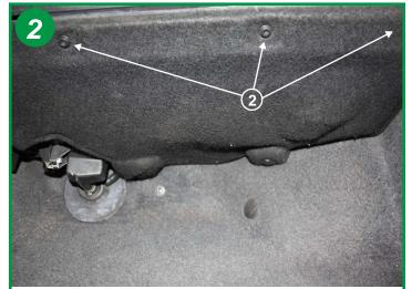
Dévisser et retirer les 3 clips plastique sous la boîte à gants pour abaisser le carter souple, il n'est pas nécessaire de le sortir totalement (2)
