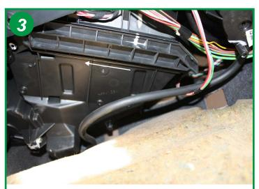
Faire coulisser le couvercle du boîtier filtre dans le sens de la flèche et le retirer.
