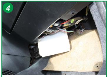
Extraire le filtre usagé par le bas et le remplacer. Le remontage s'effectue dans l'ordre inverse du démontage.
