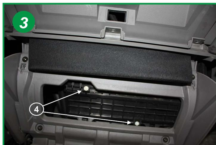
Dévisser les 2 vis de 5,5 mm de fixation du couvercle et retirez le (4).
