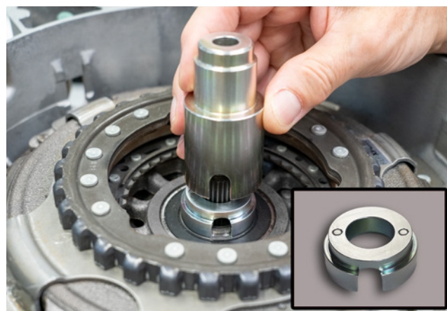
Figure 1 : Mandrin de montage associé à l'adaptateur KL-0500-6031 Z LUK
