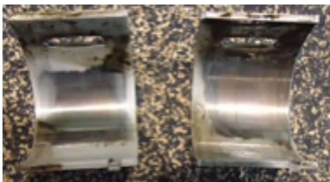
Casquillos desgastados en los que se incluso se aprecia el cobreado de la pieza.
