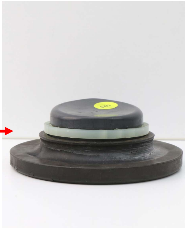
Abb. 3: Untere Federzentrierung wird wiederverwendet und mit dem Federgummi kombiniert
