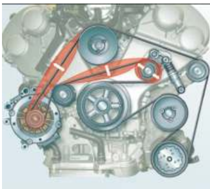
Рис. 1: Образец привода в сборе — иллюстрация вибраций, вызванных использованием обычного жесткого шкива на генераторе
