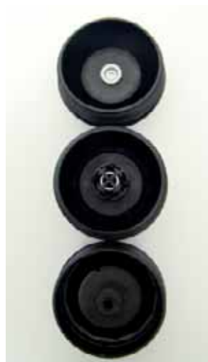
Bild 2: Ölfiler, Ansicht von innen: drei unterschiedliche Anschraubdeckel
