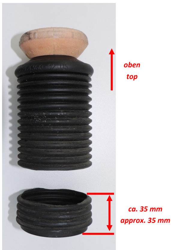
Abb. 3: OE Faltenbalg kürzen Fig. 3: Shorten the OE dust cover
