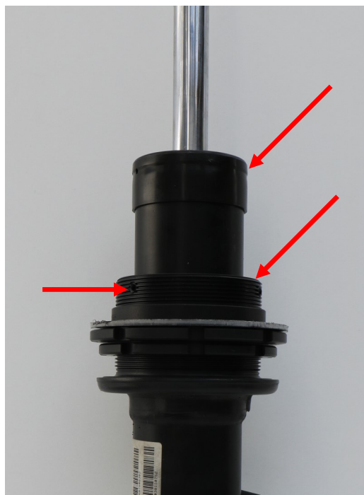
Abb. 2: Höhenverstellung und Abdeckkappe mont. Fig. 2: Mount the height adjustment and cap
