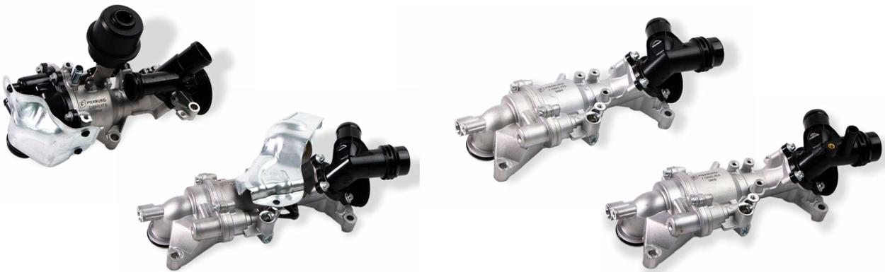
Motorservice hat vier neue Pierburg Wasserpumpenmodule in sein Aftermarket-Programm aufgenommen. Mit jetzt sechs Produkten von Pierburg deckt Motorservice alle Wasserpumpen für die 1,6-l- und 2,0-l-Benzin-Turbomotoren (M270 und M274) von Mercedes-Benz ab.
