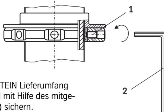
Den Federteller mit dem im BILSTEIN Lieferumfang enthaltenen Gewindestift (1) und mit Hilfe des mitgelieferten Innen-6kt-schlüssels (2) sichern.
