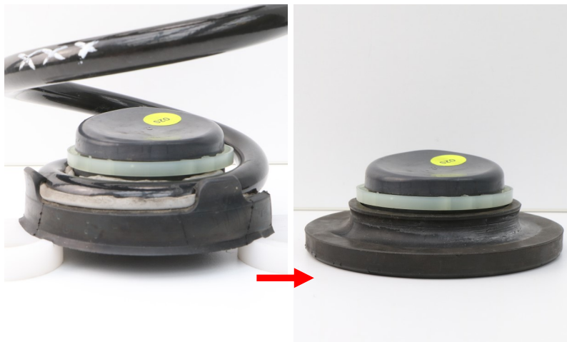
Abb. 3: Untere Federzentrierung wird wiederverwendet und mit dem oberen Federgummi kombiniert
