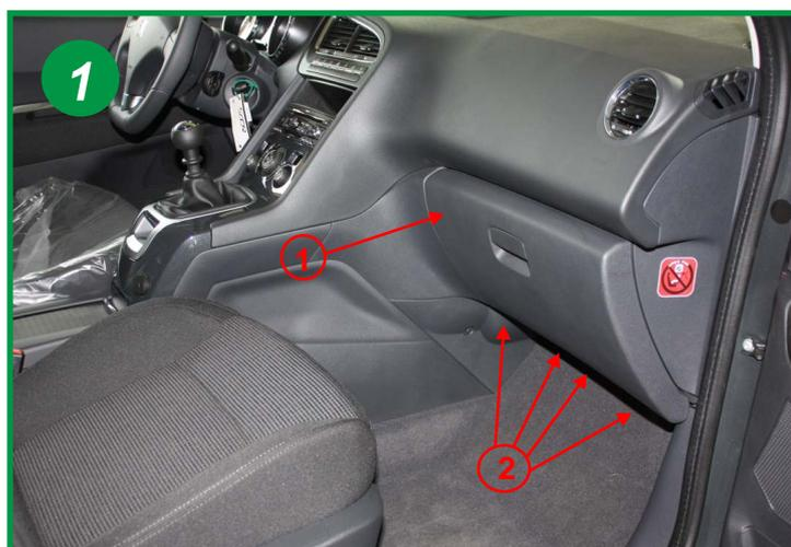
Les filtres d'habitacle sont situés à l'intérieur du véhicule, coté passager derrière la boîte à gants (1). Retirer la garniture dessous celle-ci en enlevant les 4 clips plastique de maintien (2).
