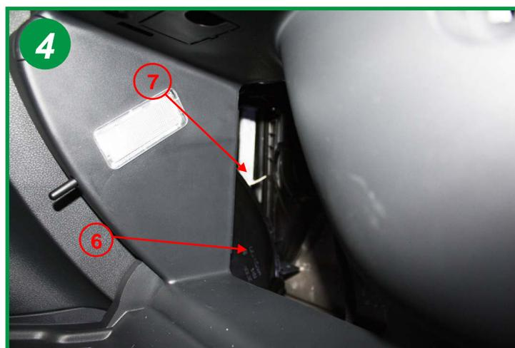
Retirer le couvercle d'entrée du boitier et enlever les filtres d'habitacle usagés en tirant sur des languettes prévues à cet effet (7), ils sont placés l'un sur l'autre. Le remontage s'effectue dans l'ordre inverse du démontage.
