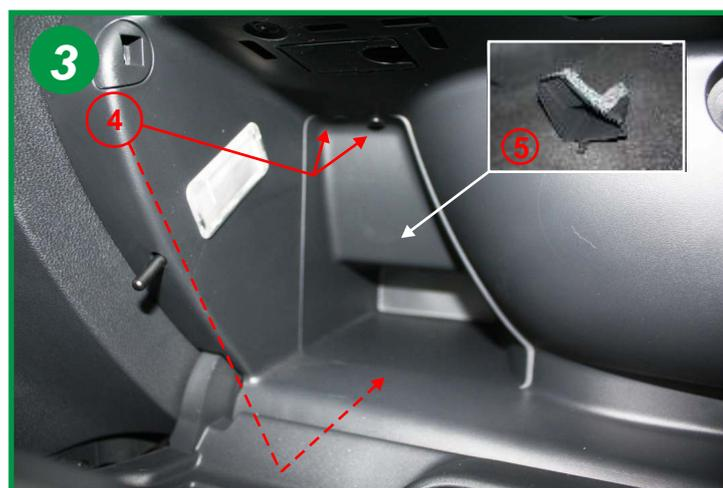
Dévisser les 3 vis (4) et retirer la pièce plastique (5) par le dessous. Tirer ensuite sur le conduit de ventilation vers le bas sans l'enlever (le conduit est en 2 pièces qui couissent l'une dans l'autre). Repère 6 sur la photo suivante.
