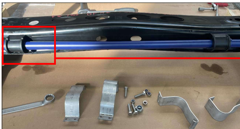
Abb. 3 & 4: Lagergummi Positionierung durch Stellringe Fig. 3 & 4: Positioning of bearing rubbers via adjustment rings
