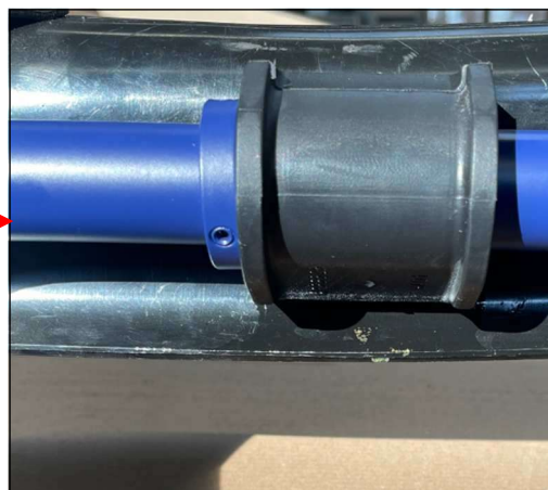
Abb. 2: Befestigung der Stabilisatorenden Fig. 2: Mounting of the Anti-Roll Bar ends
