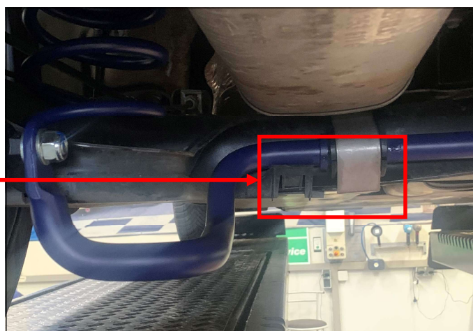
Abb. 5 & 6: Ausklinken des Steinschlagschutzes (fahrzeuginnere Klemmbefestigung wird entfernt) Fig. 5 & 6: Cut out of the stone chip protection (clamp towards the centre of the car gets removed)
