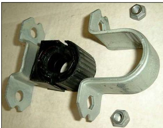
Abb. 3: Demontierte OE Lagerschellen & -gummis Fig. 3: Dismantled OE stabilizer clamps and rub-
