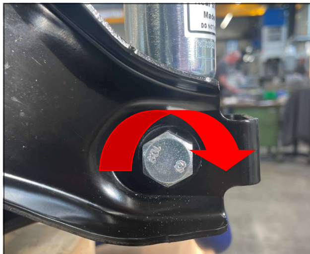
Abb. 10: Anziehen der HA-Stoßdämpferschraube
