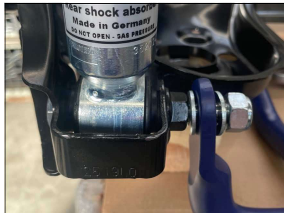
Abb. 2: Befestigung der Stabilisatorenden Fig. 2: Mounting of the Anti-Roll Bar ends
