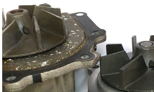
Image 1 : Roue à aubes déplacée avec traces de frottement (à gauche), position correcte de la roue à aubes (à droite)
