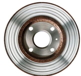
Cambiar por pares los discos con corrosión, grietas, o con desgaste excesivo.
