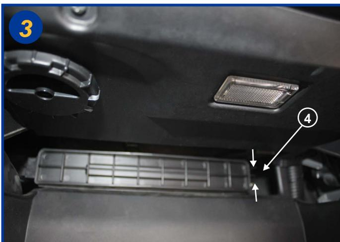
Ouvrir le boîtier filtrant à droite (4) en actionnant les 2 fermetures dans le sens des flèches.
