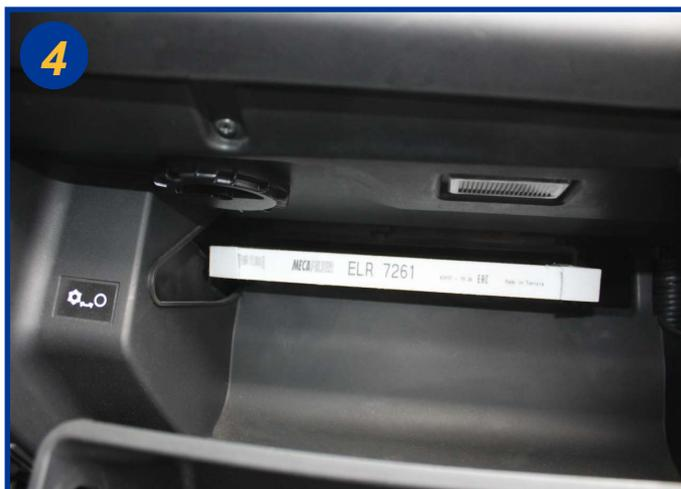
Retirer l'élément filtrant de son boîtier et le remplacer.
