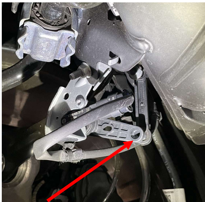
Abb. 1: Austausch der Niveauregelstangen HA (Abb. ähnlich) Fig. 1: Exchange of the level control rods RA (Fig. may vary)
